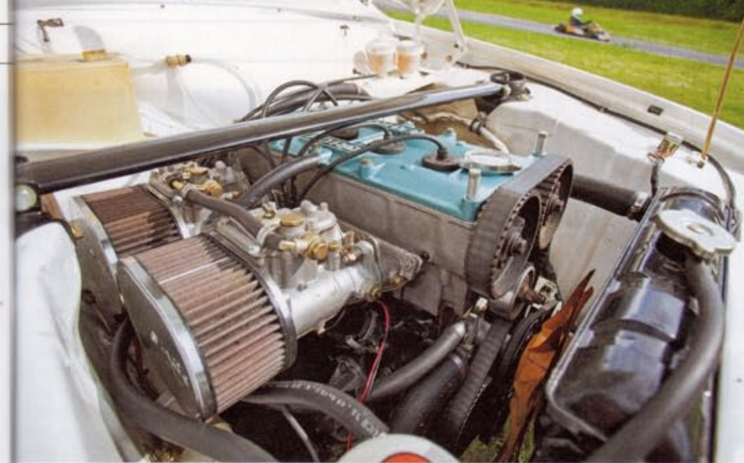
Das ist er: der berühmte Cosworth-BDA-Motor mit seinem komplizierten Belt-Drive (Zahnriemenantrieb), hier mit zwei Weber-Doppelvegasern. Der Vierzylinder spuckte bis zu 270 PS aus – und galt doch als äußerst robust
