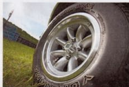
Minilite-Räder, ursprünglich aus Magnesium, waren damals das Coolste überhaupt. Innen ein Armaturenbrett als aufgeräumtes Uhrenkabinett. Ohne Rücksicht aufs Gehör sind 8000 Umdrehungen machbar, Spitze je nach Übersetzung
