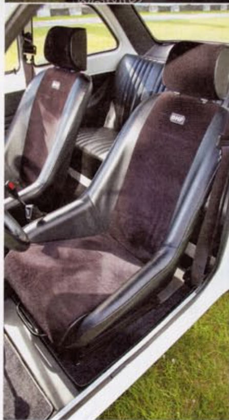
Die Schalensitze sind im Inneren das Einzige, das an den wahren Zweck des Autos gemahnt: volles Kanonenrohr zu fahren. Außen sind es die kleinen RS-Symbole, die Minilite-Räder und die dicken Backen. Bei Kopien auf Standard-Escort-Basis sind sie aus Plastik, bei den raren Originalen aus Stahl
